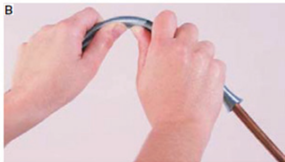
Fig. 3.17. a). Lakimi me sustë (feder); b). Madhësi të ndryshme të sustave (federeve).
