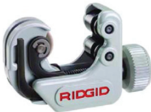
Fig. 3.13. Ky prerës i vogël i tubave me qëllim të posaçëm mund të përdoret për t'i prerë tubat deri në 1 1/8 "OD, ku ka hapësirë të vogël (Kompania Ridge Tool)
